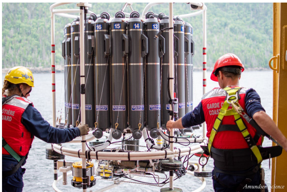
Photo 2 : Déploiement de la CTD-Rosette et test des capteurs variés sous les bouteilles Niskin et sur le cadre de la rosette.
