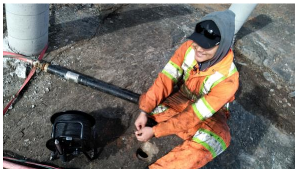
Figure 1. Mesure d'un profil de température effectué à Kuujjuaq par un Inuk en apprentissage du métier de foreur.
